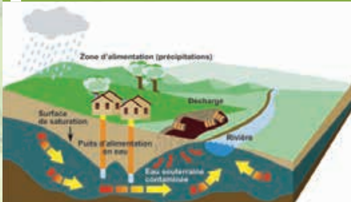
Figure 3.42 Schéma de contamination des eaux souterraines par une décharge
