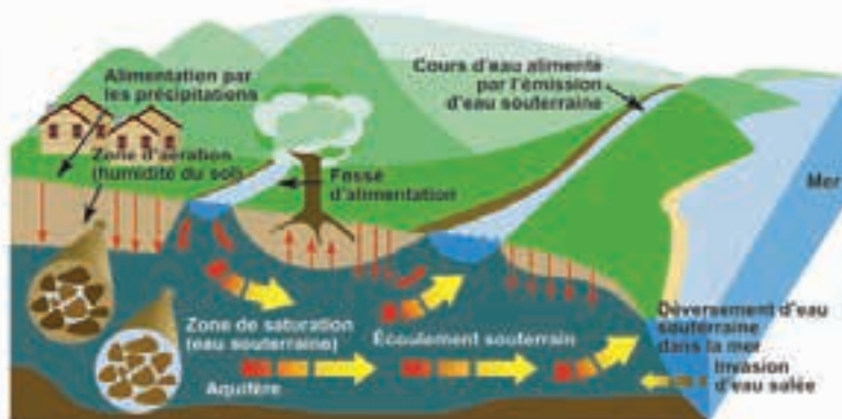
Figure 3.34 Schéma d'écoulement de l'eau souterraine
